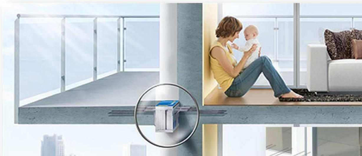
Обеспечивает непрерывное термическое отсечение внешних неизолированных конструкций от теплового контура здания, обеспечивая при этом большую однородность теплового контура.
