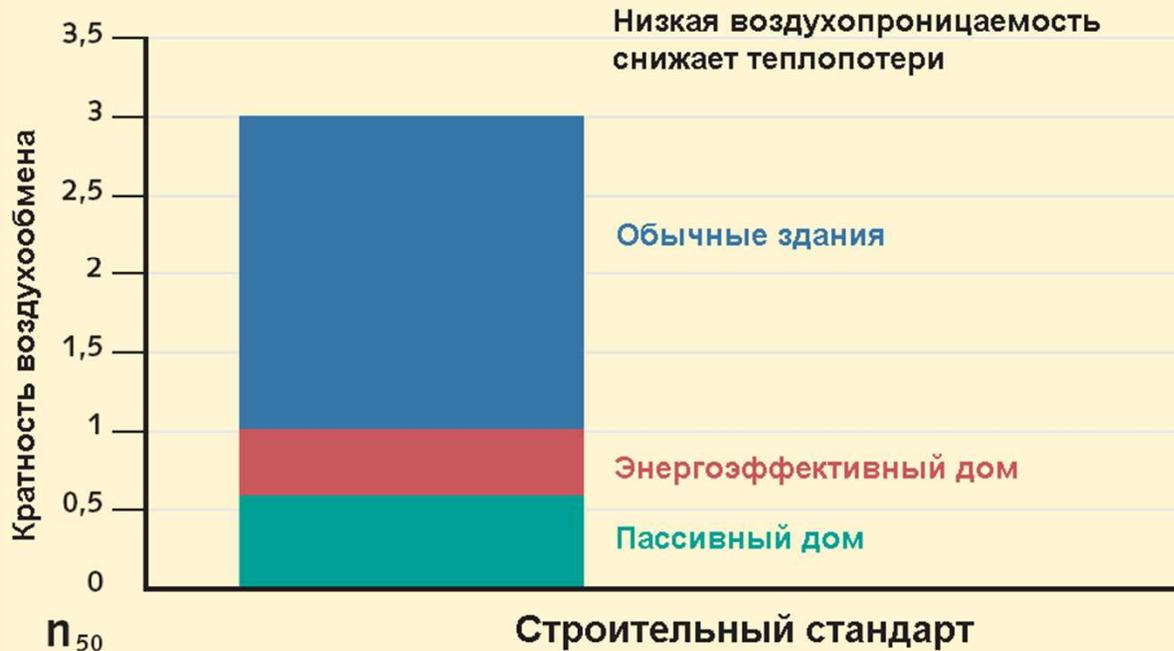
В Мультикомфортном доме имеет место контролируемый воздухообмен с постоянным притоком свежего воздуха.
